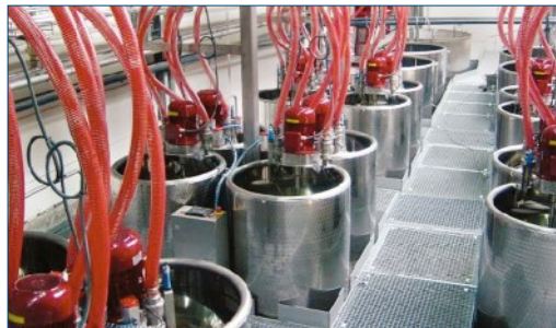
图为 配浆站, 带有自动计量增稠剂及水的计量仪
