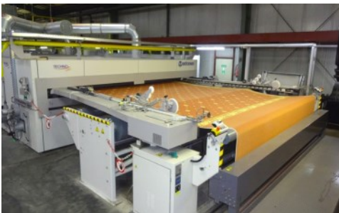
图为烘箱入口处的拉幅定型
