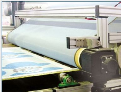
图为地垫及方块毯所用的三明治清洗装置
