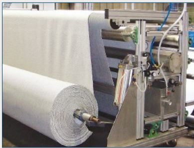
图为退卷装置，配有预蒸，对边及拉辊牵引
