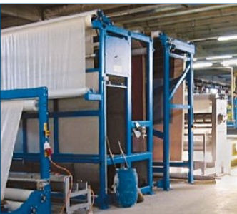
图为上卷, J型集布架, 除絮装置, 预蒸, 对边装置, 拉辊
