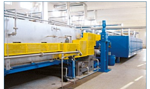
图为水平式蒸箱、清洗装置及烘箱
