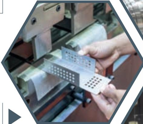
Manuelle Blechbearbeitung Baustahl und Edelstahl: zuschneiden, stanzen, ausklinken, abkanten
