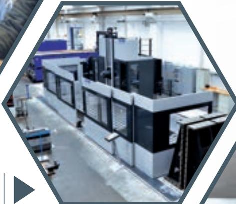
Großteilebearbeitung auf 5-Achs-Fahrständer-Fräsmaschine
