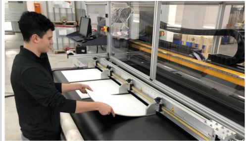
方块毯地垫定位装置能精准定位印花毯宽度,只要动动手指调整一下 毯基的尺寸即可单片印花。
